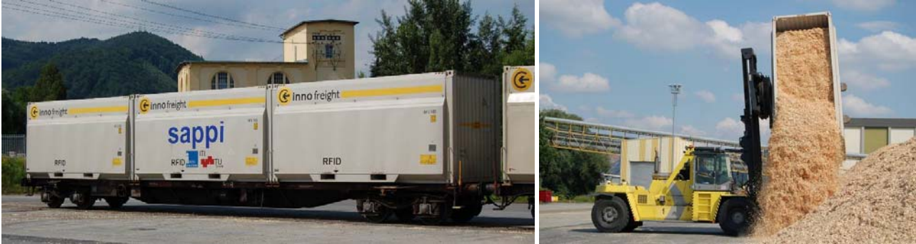
Abbildung 27: Wechselcontainer der Firma Inno freight auf Waggon und bei Entladung mit Stapler
