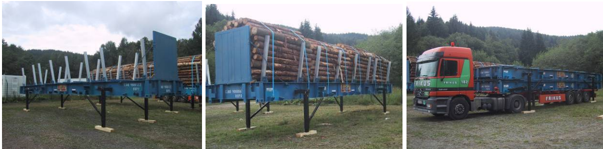
Abbildung 22: Von links nach rechts: Leerer LogRac, beladener LogRac, zusammengeklappte und gestapelte LogRacs (Institut für Forsttechnik)
