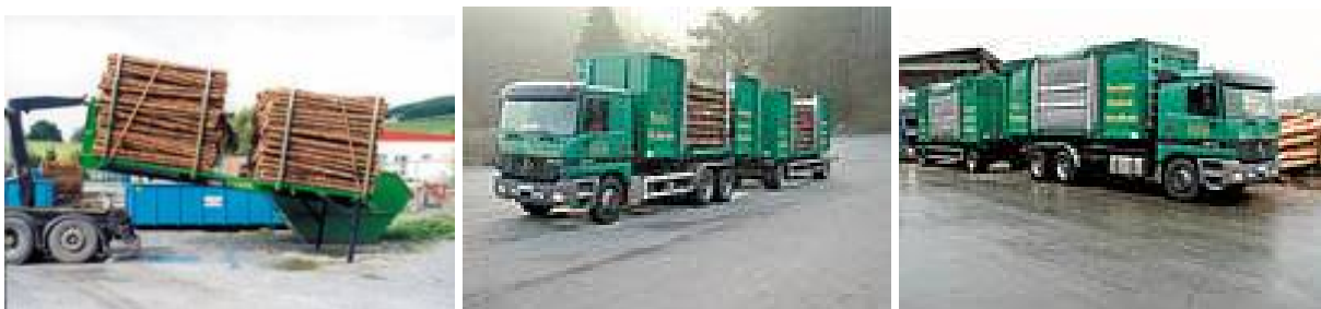
Abbildung 21: Von links nach rechts: Euroflat mit Rundholz beladen, Kombi-Euroflat mit Rundholz beladen (Strunk, 2003), geschlossener Kombi-Euroflat ( www.kraemer-fahrzeugbau.de )
