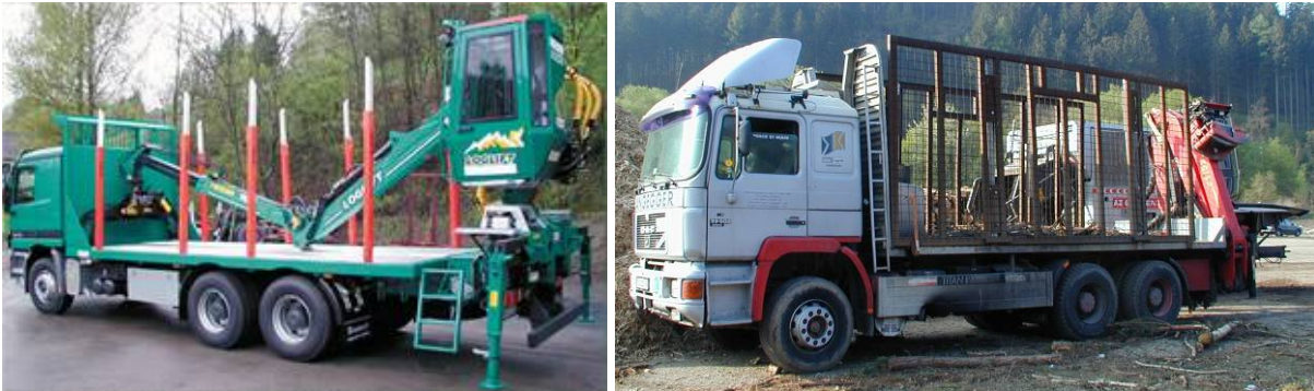
Abbildung 8: Links: Kurzholz-LKW mit Rungen ( www.kraemer-fahrzeugbau.de ), rechts: Kurzholz-LKW mit Rungenaufbau und Einsatzwänden (Institut für Forsttechnik)
