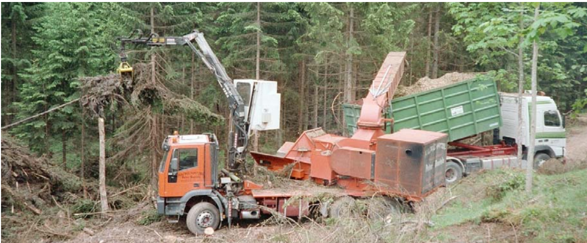
Abbildung 58: Hacken von Schlagabraum mit Direktbeladung in Container-LKW
