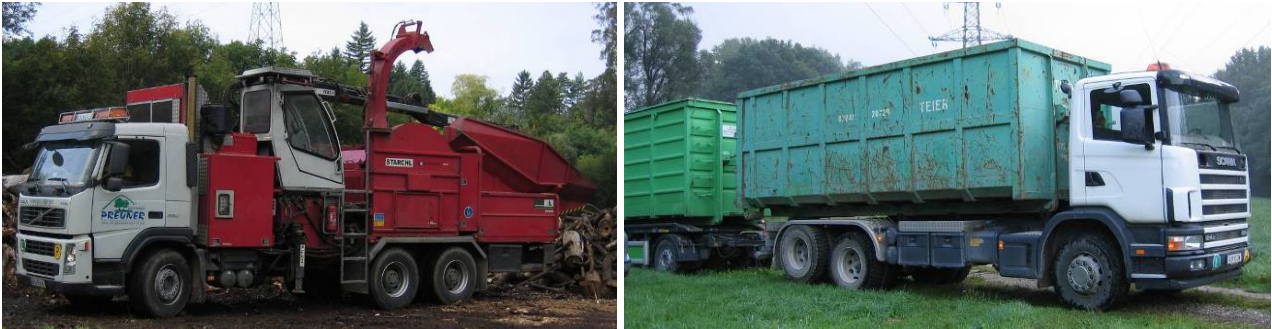
Abbildung 61: Hacker Starchl 1200-800 auf LKW und LKW-Zug mit Abrollcontainern zu je 36 SRM Fassungsvermögen
