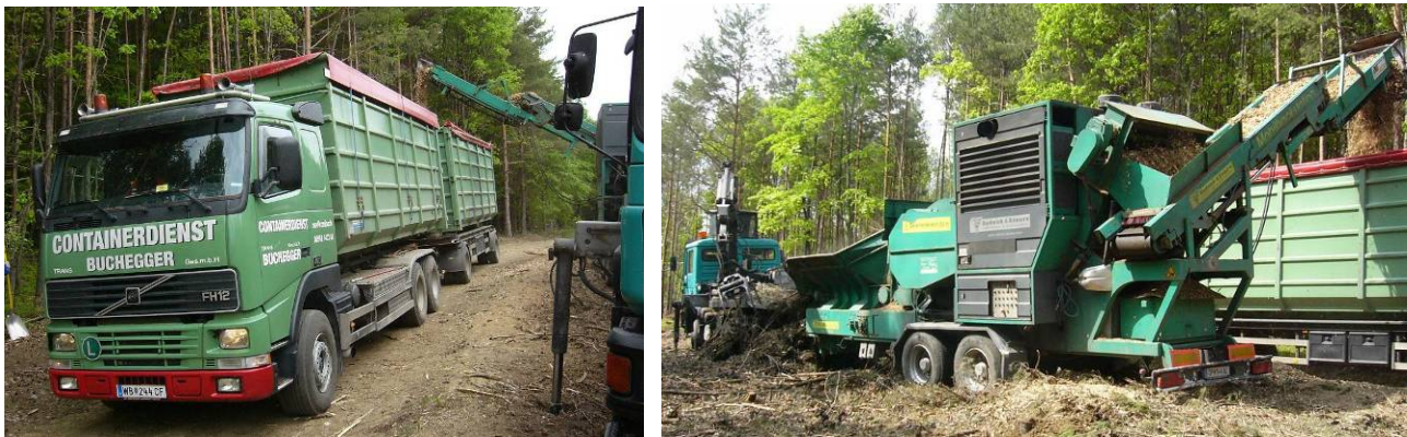
Abbildung 164: Hacker bei der Beschickung auf einen LKW-Zug mit Abrollcontainern
