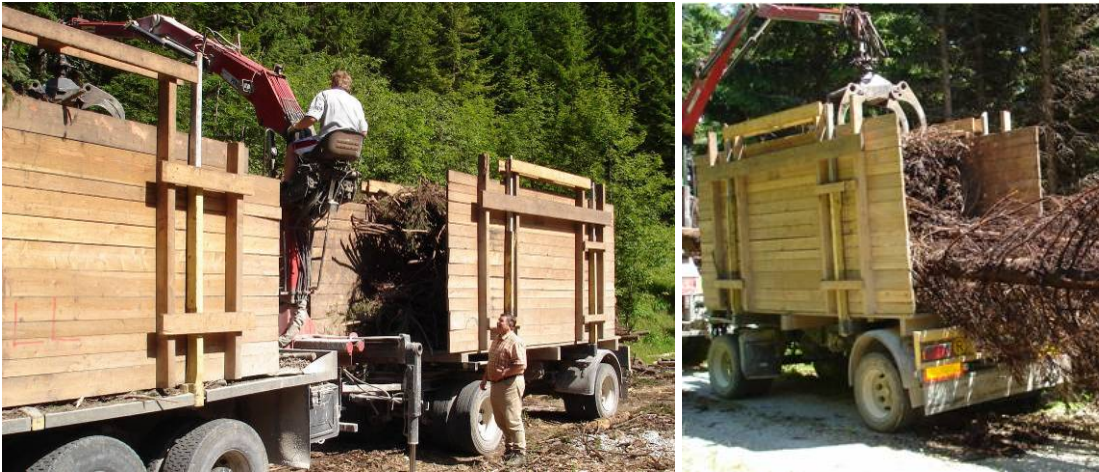
Abbildung 93: Rundholz-LKW mit Anhänger, ausgestattet mit Bordwänden aus Holz
