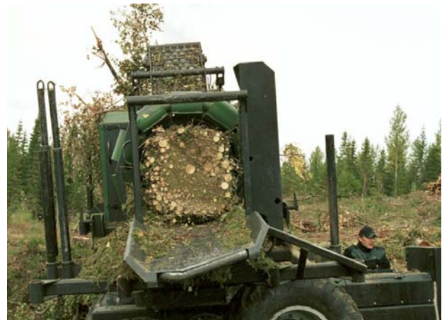
Abbildung 64: Bündeln von Schlagabraum – Transport mit Rungen-LKW – Hacken beim Werk
