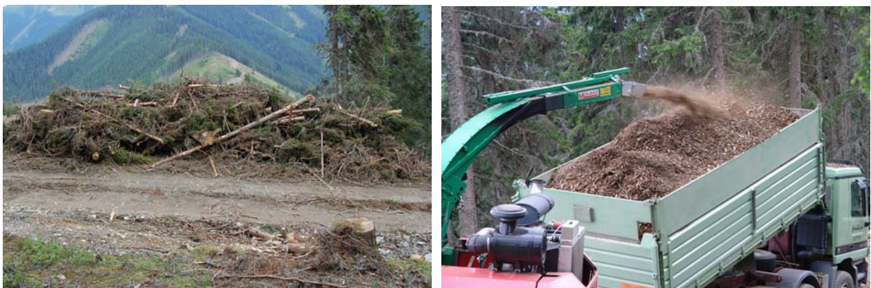
Abbildung 60: Lagerung von Schlagabraum an der Forststraße und Hacken in bereitgestellte Schüttgut-LKW
