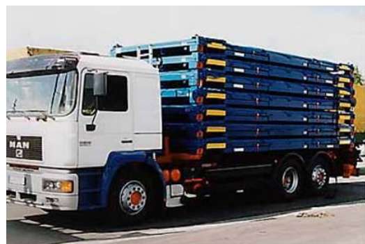
Abbildung 20: Links: Wechselbrückenfahrzeug mit Wechselbrücke ( www.bruder-spielzeug.de/ ), rechts: Zusammengeklappte und gestapelte Wechselbrücken (Strunk, 2003)
