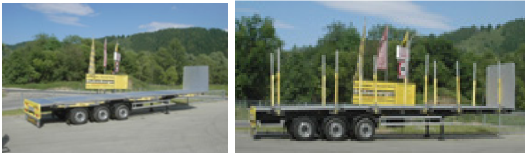
Abbildung 25: WoodTrailer mit um- und aufgeklappten Rungen (www.innofreight.at, 2006)
