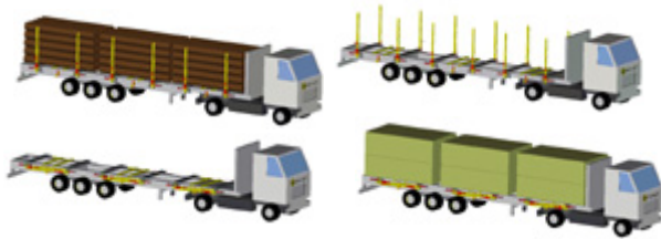
Abbildung 24: WoodTrailer Rundholztransport und Schnittholztransport, (www.innofreight.com, 2006)
