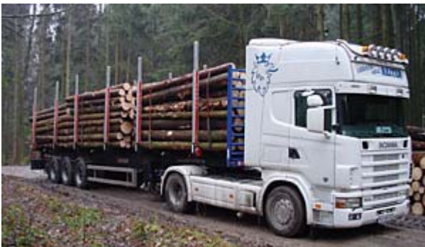
Abbildung 11: Rundholzsattelzug ohne Ladekran
