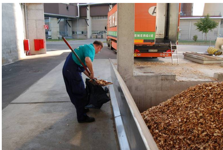
Abbildung 144: Übernahme und Qualitätsbestimmung am Heizwerk
