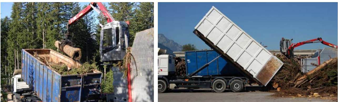
Abbildung 67: Verdichten des Schlagabraumes mittels Stammholzabschnitt und Entladen des Abrollcontainers am Werk
