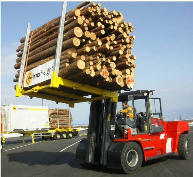
Abbildung 18: Rundholzpalette mit 16t Stapler, (Wanek-Pusset, 2005)
