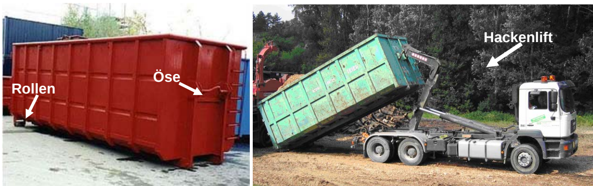
Abbildung 14: Links: Abrollcontainer ( www.bcs-container.de/abrollcontainer.html ), rechts: Abrollkipper (Institut für Forsttechnik)
