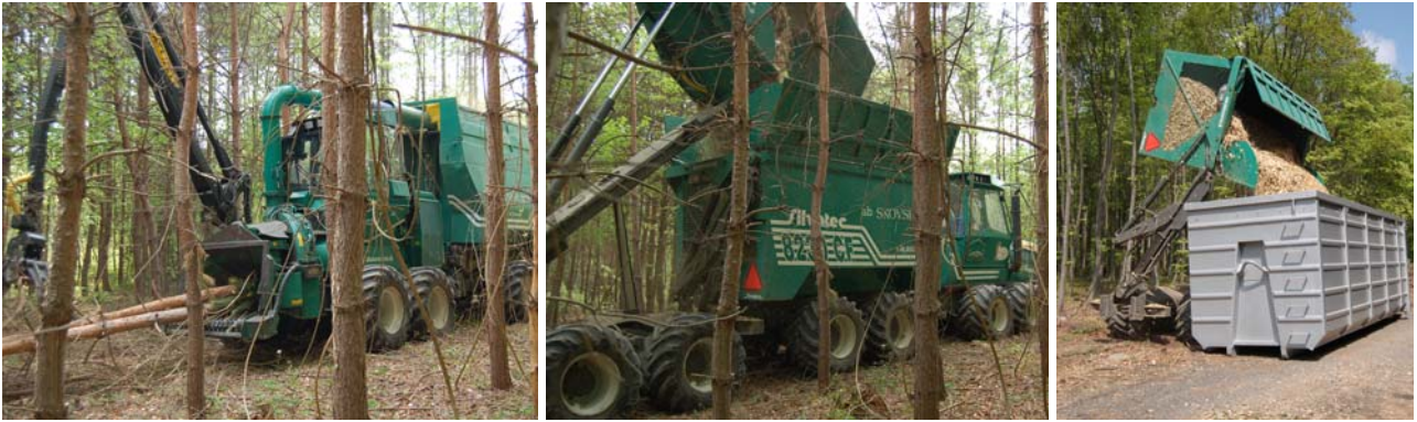
Abbildung 71: Mobiler Hacker, Forwarder mit Hochkippl-Container, Abrollcontainer
