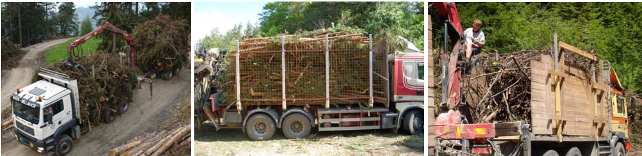
Abbildung 62: Rungen-LKW ohne Bordwände, mit Stahlgitterkasten und mit Bordwänden
