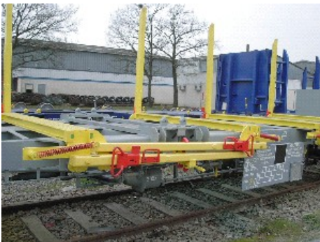
Abbildung 33: Drehungensystem am Rungen-Waggon „WoodRailer“ mit umgeklappten Rungen im Vordergrund ( www.innofreight.com , 2006)
