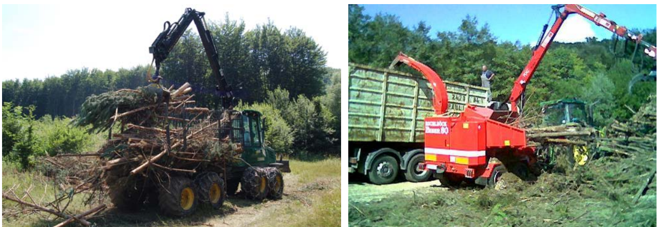
Abbildung 76: Ausfuhr von Energierohholz und Wipfel sowie Hacken in Container-LKW
